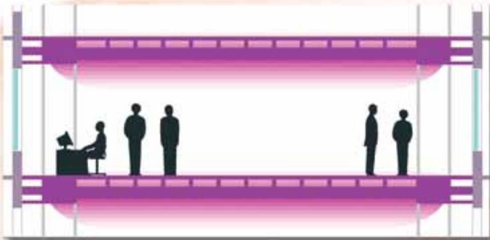
Snittegning gjennom hovedkontoret til GSW i Berlin, der eksponert betong i himlingen akkumulerer overskuddsvarme på dagtid (venstre). Overskuddsvarmen ventileres bort nattestid ved naturlig kryssventilasjon (høyre).
